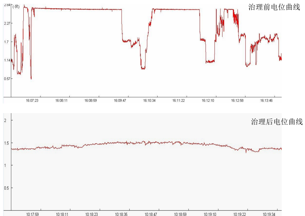
图 4 动态杂散电流治理前后的管地电位对比图
