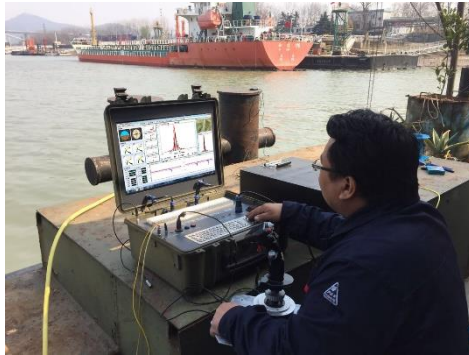
图 3 River-ROV 测量管道路由及埋深
