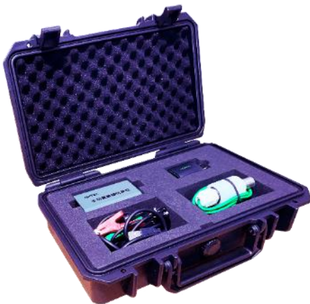
图 1.1 多功能数据记录仪 MDL 的组成
