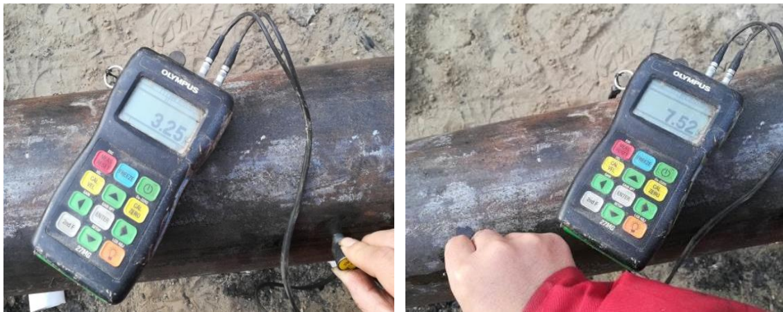
现场壁厚测量
