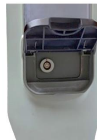
图 3.3 PDM 接收机充电接口
