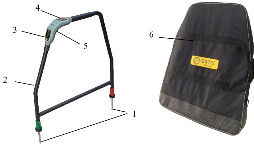
图 4.1 智能 A 字架结构图
