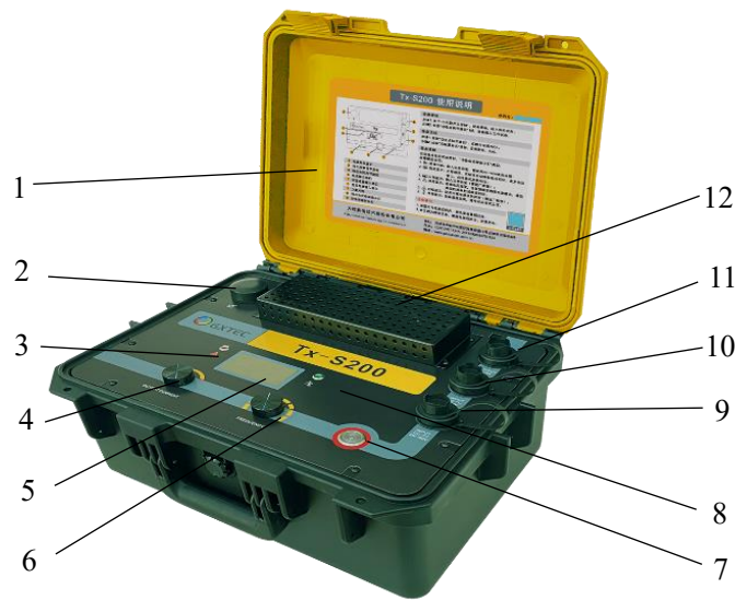
图 2.2 发射机的面板说明
